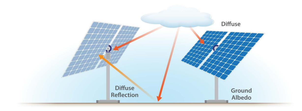
$$G_{rear} = G_{diffuse,r} + G_{reflected,r} + G_{beam,r}$$
