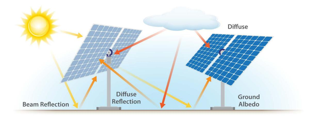
$$G_{rear} = G_{diffuse,r} + G_{reflected,r} + G_{beam,r}$$
