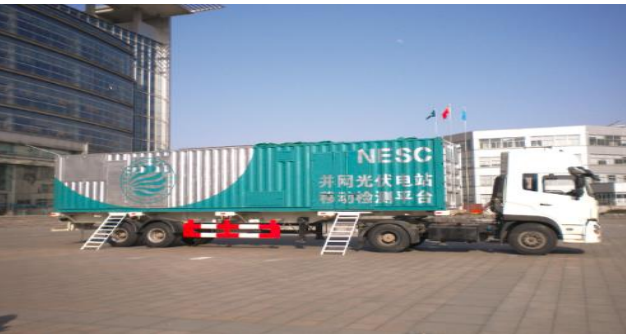
分布式光伏发电系统移动检测平台
