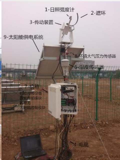
旋转式太阳能测量系统 Rotary solar measurement system
