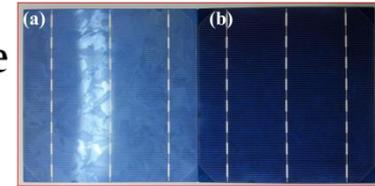
图2: (a) 金刚石线切割多晶硅片常规制绒电池片; (b) 金刚石线切割多晶硅片新工艺制绒电池片
